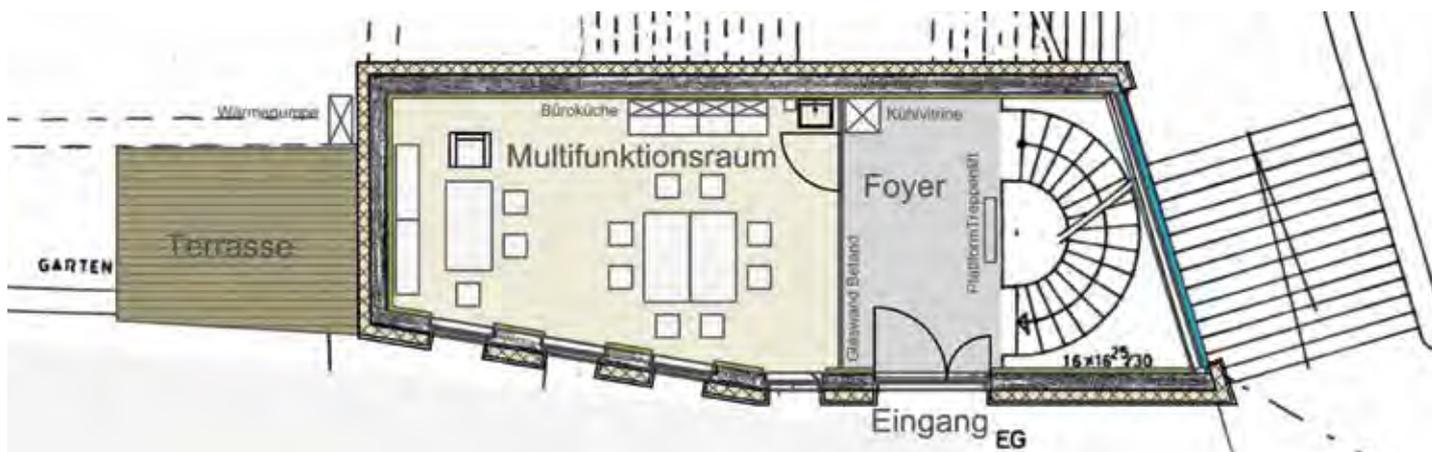
Der bestehende Eingang im Erdgeschoss des Gebäudes wird versetzt und vergrößert, um die barrierefreie Erschließung zu ermöglichen. Der dort befindliche Raum soll als Multifunktionsraum dienen.
